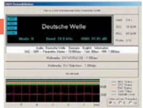
Ein Mausklick auf die Schaltfläche DRM aktiviert den integrierten DRM-Decoder des FDM77. Er basiert auf dem Fraunhofer-Software-Radio und zeigt im unteren Bereich die Signalqualität über die Zeit an.
