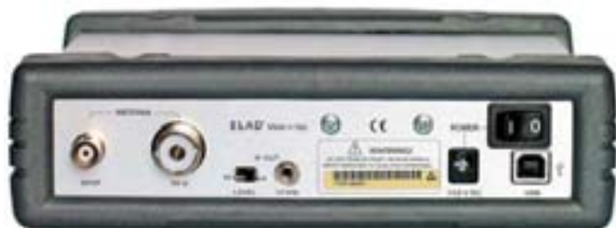
Das rückwärtige Anschlussfeld des FDM77. Dort liegt auch der An-/Ausschalter.
